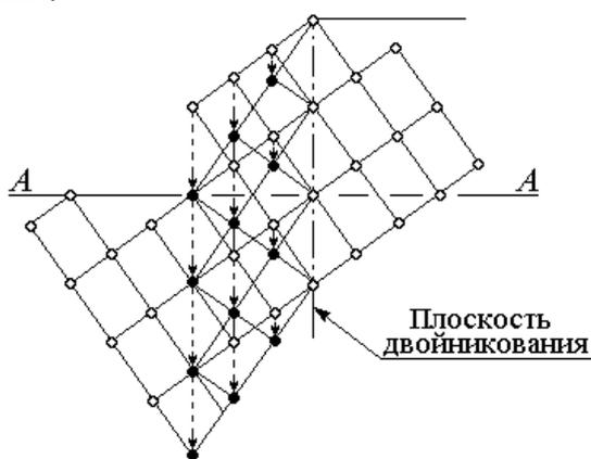
**Рис. 1.17.** Схема двойникования
