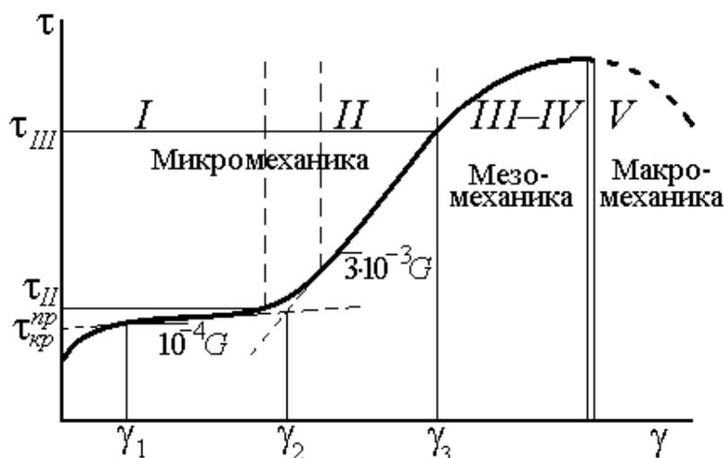
**Рис. 1.19.** Вид кривой «напряжение – деформация» и соответствующие масштабные уровни деформационного упрочнения
