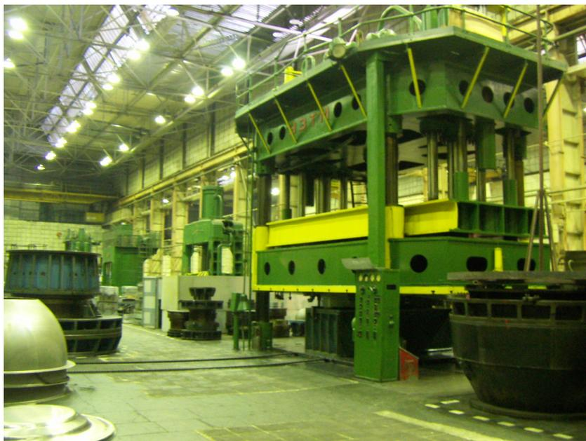
Рисунок 2.11 – Вид гидравлического пресса силой 10 МН
