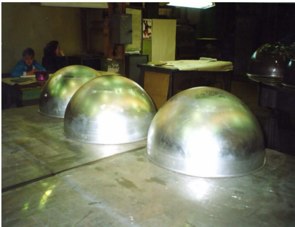
Рисунок 4.1 – Вид детали «диафрагма» из алюминиевого сплава А5М
