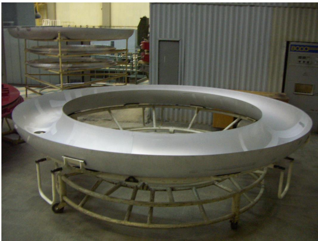
Рисунок 6.1 - Полуторовое днище из алюминиевого сплава АМг6
