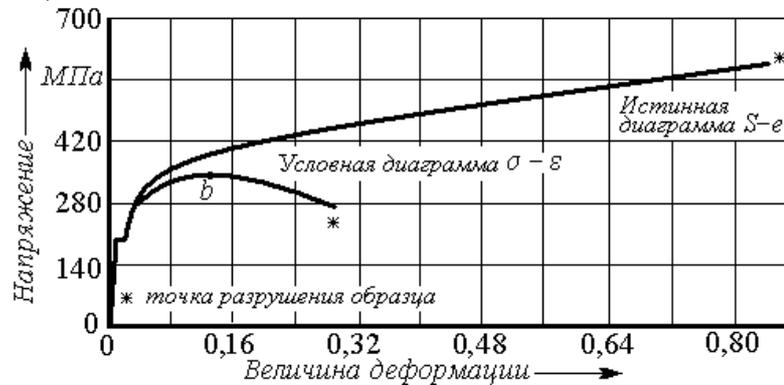
**Рис. 1.2.** Общий вид условной  $\sigma - \varepsilon$  и истинной  $S - \varepsilon$  диаграмм деформации для низкоуглеродистой стали
