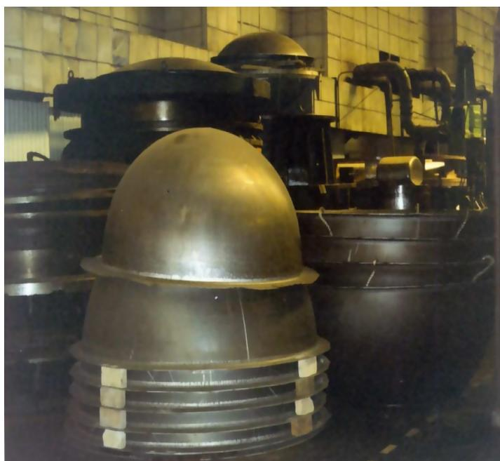
Рисунок 2.12 - Вид полусферических тонкостенных днищ из листов титанового сплава ПТ-3Вкт
