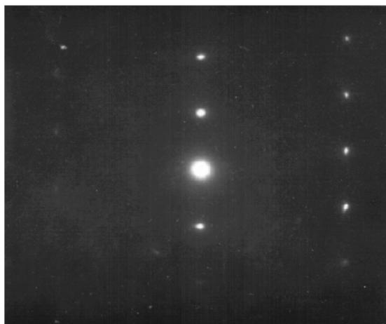
Рисунок 7.14 - Электронномикроскопическое изображение поверхности разрушения (x30000) охрупченного листа сплава ПТ-3Вкт и микродифракционная картина с частицы, указанной стрелкой
